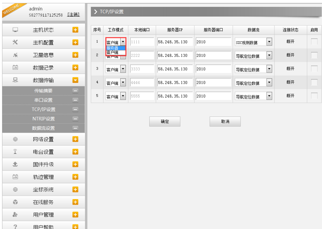
图 2.4-20 Web UI 数据传输-TCP/IP 设置：服务器
