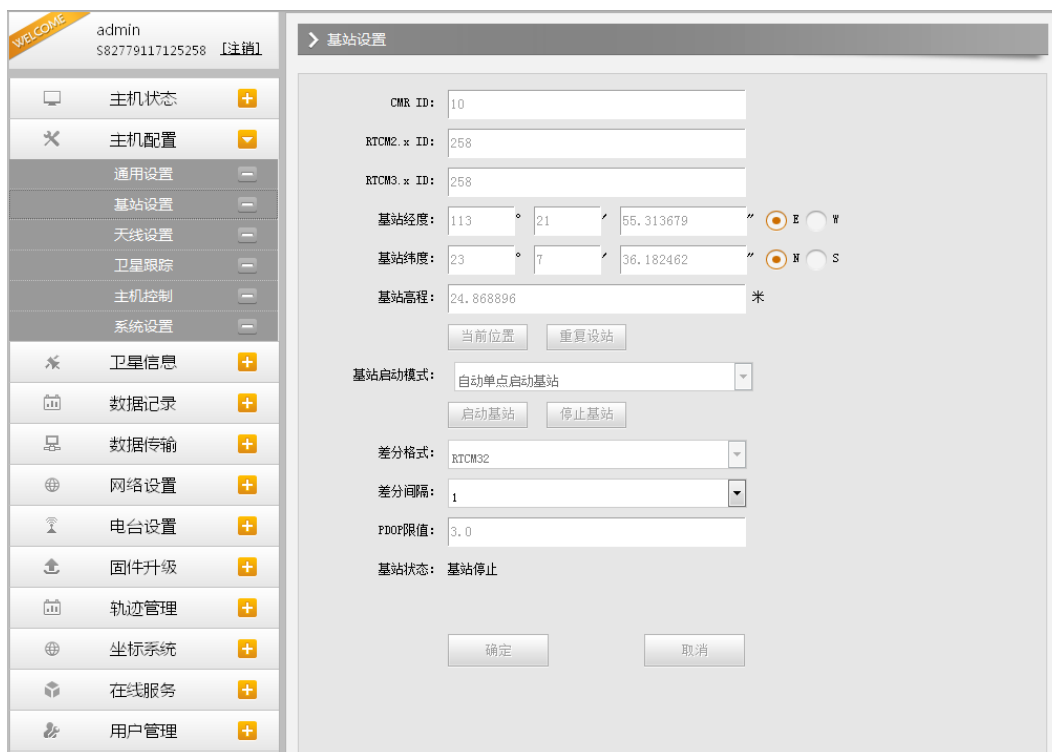
图 2.4-7 Web UI 主机配置-基站设置
