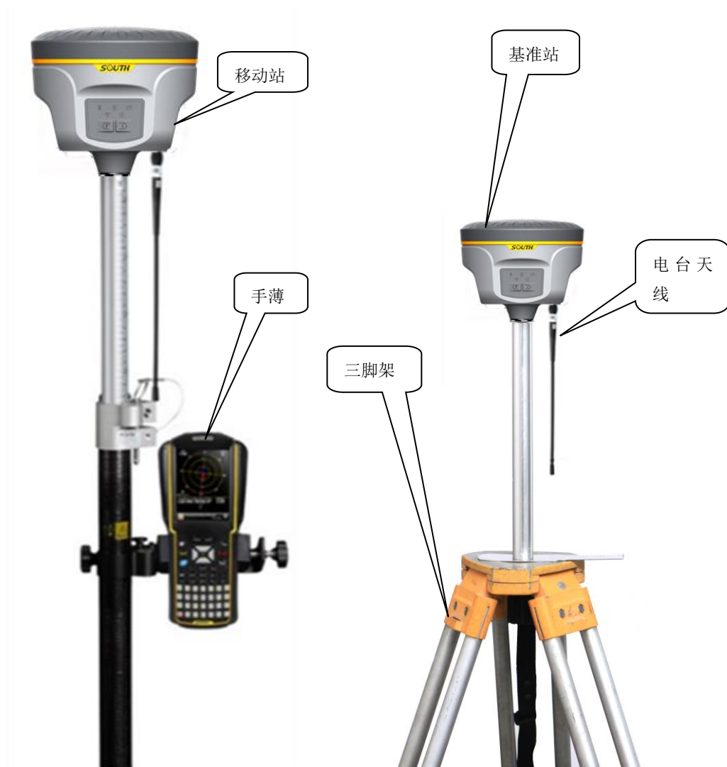
银河 1plus 测量系统示意图
