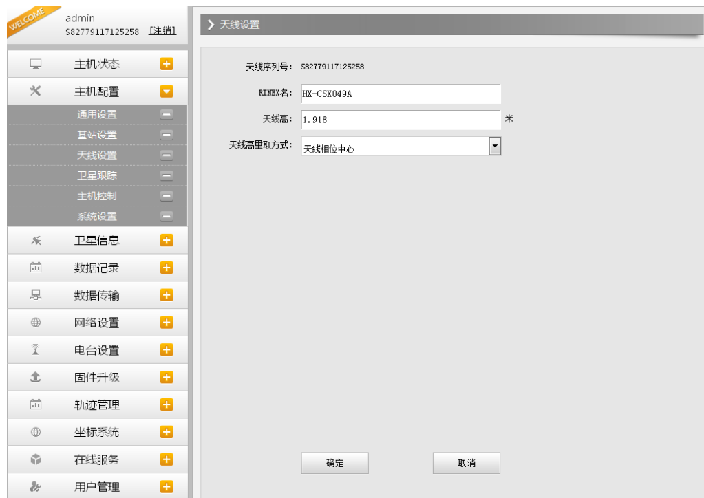
图 2.4-8 Web UI 主机配置-天线设置
