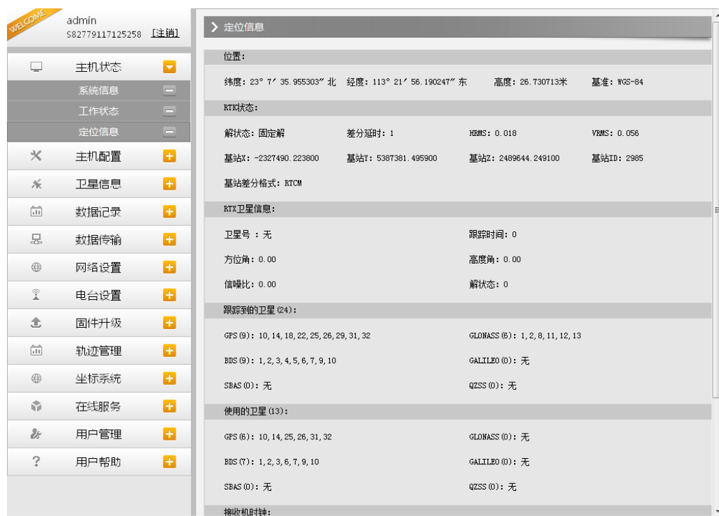
图 2.4-5 Web UI 主机状态-定位信息
