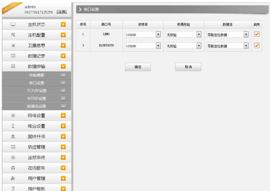
图 2.4-17 Web UI 数据传输-串口设置
