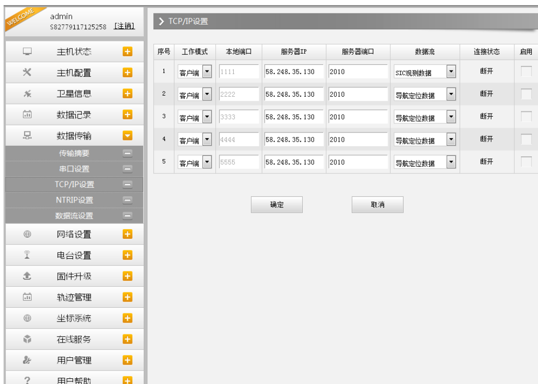
图 2.4-19 Web UI 数据传输-TCP/IP 设置：客户端
