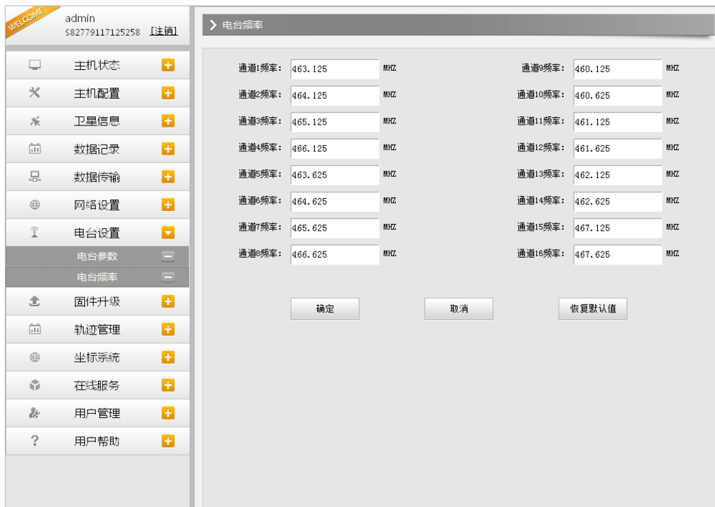
图 2.4-33 Web UI 电台设置-电台频率
