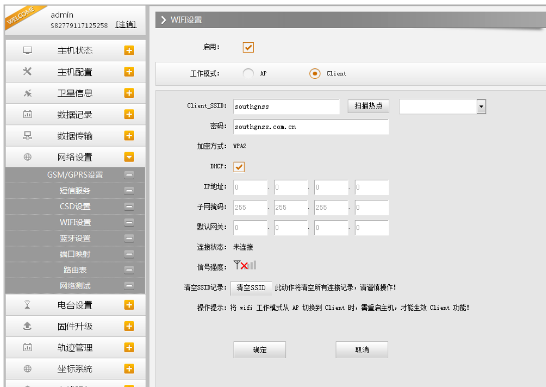
图 2.4-27 Web UI 网络设置-WIFI Client 模式设置
