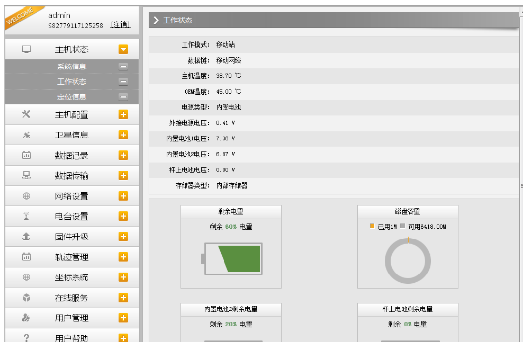
图 2.4-4 Web UI 主机状态-工作状态
